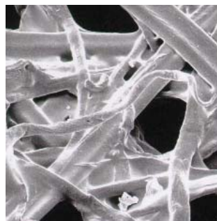
Cartouche filtrante (cellulose) Surface grossière, structure grande, filtration en profondeur
