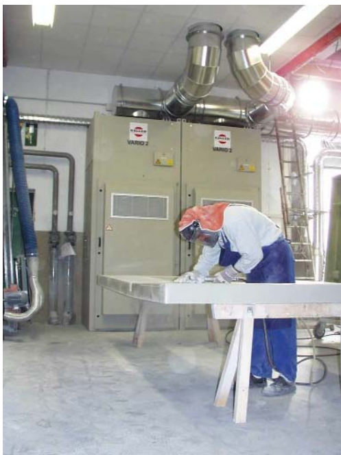
Aspiration et filtration lors du ponçage de produits en résine de fibres de verre
