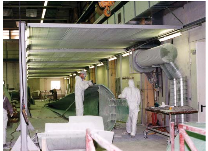
Cabine insonorisée avec captation et filtration intégrées.
