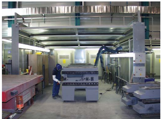
Cabine insonorisée avec éléments de captation et de filtration intégrés. Domaine d'activité : Ponçage de bâtis de machines
