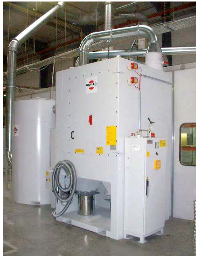
Façonnage laser du bois, environ 3000m 3 /h
