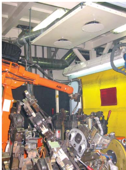
Aspiration de robots lors de la fabrication d'éléments de siège
