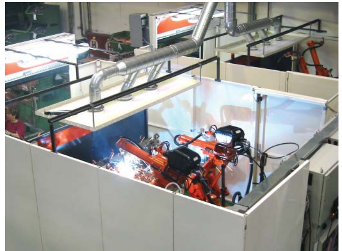
Aspiration de robots de soudage avec capot d'aspiration
